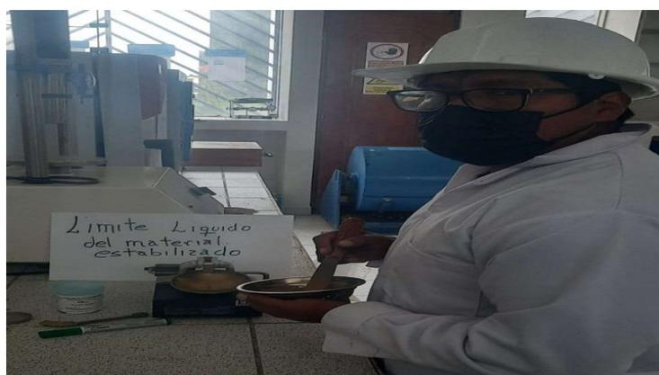
**Imagen 15** Limite Liquido con la Cuchara de Casagrande
