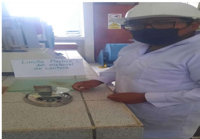
Imagen 11 Pesando la muestra para determinar el Limite Plástico
