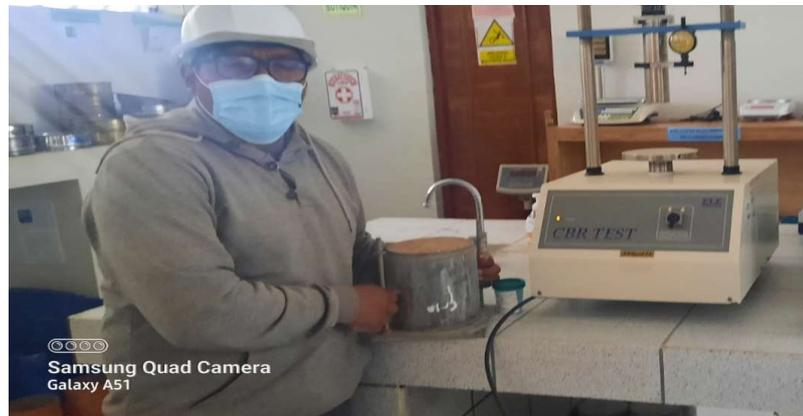
**Imagen 16** Prensa de Penetración maquina CBR
