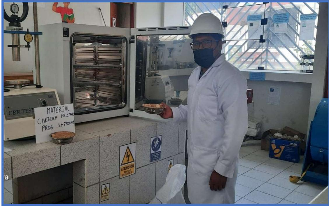
**Fotografía 04:** secado de la muestra en el horno a  $110 \pm 5 \text{ }^\circ\text{C}$
