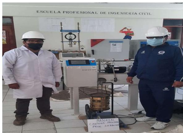
**Imagen 10** Tamizado en el agitador de tamiz
