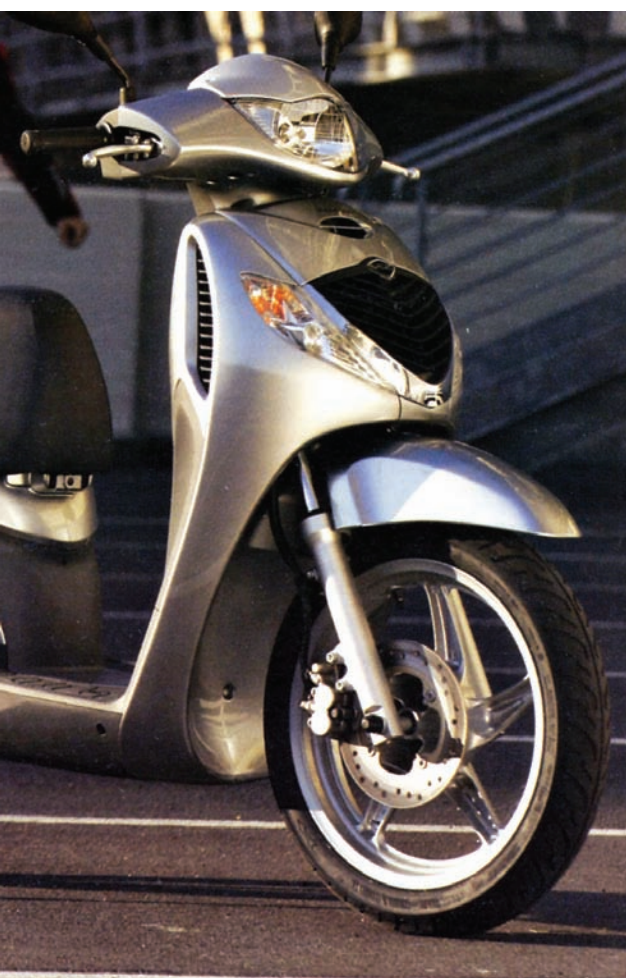
Pinza a doppio pistoncino Nissin su Honda SH 150i Nissin double piston brake disc on a Honda SH 150i
