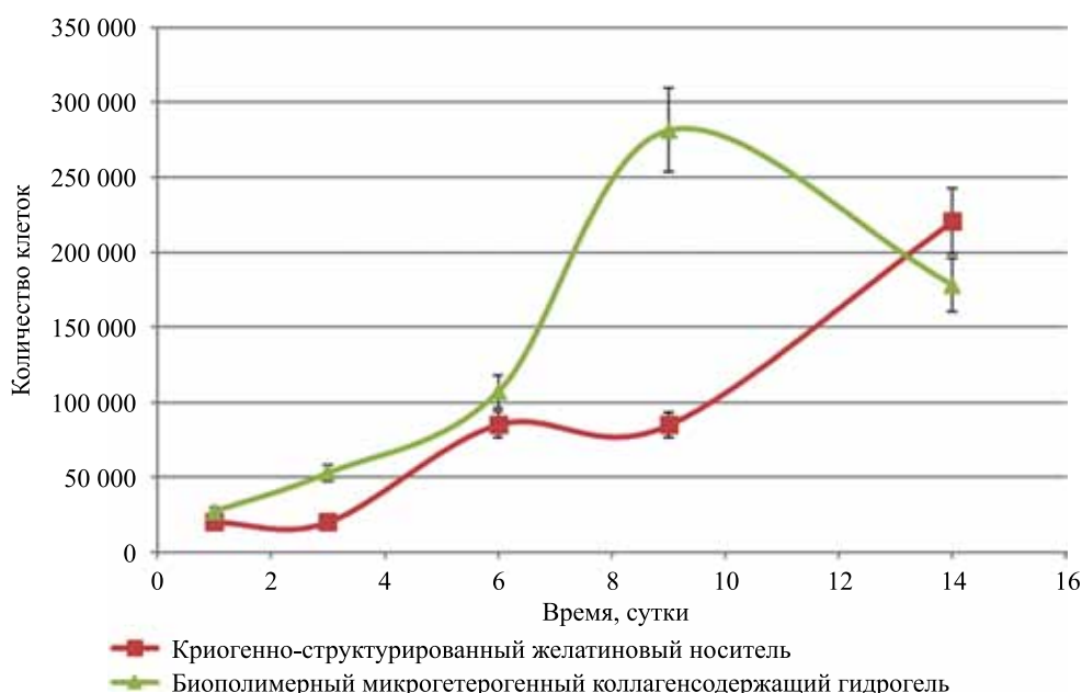
Рис. 3. Кривые роста МСК ЖТч на криогенно-структурированной желатиновой губке и биополимерном коллагенсодержащем гидрогеле
