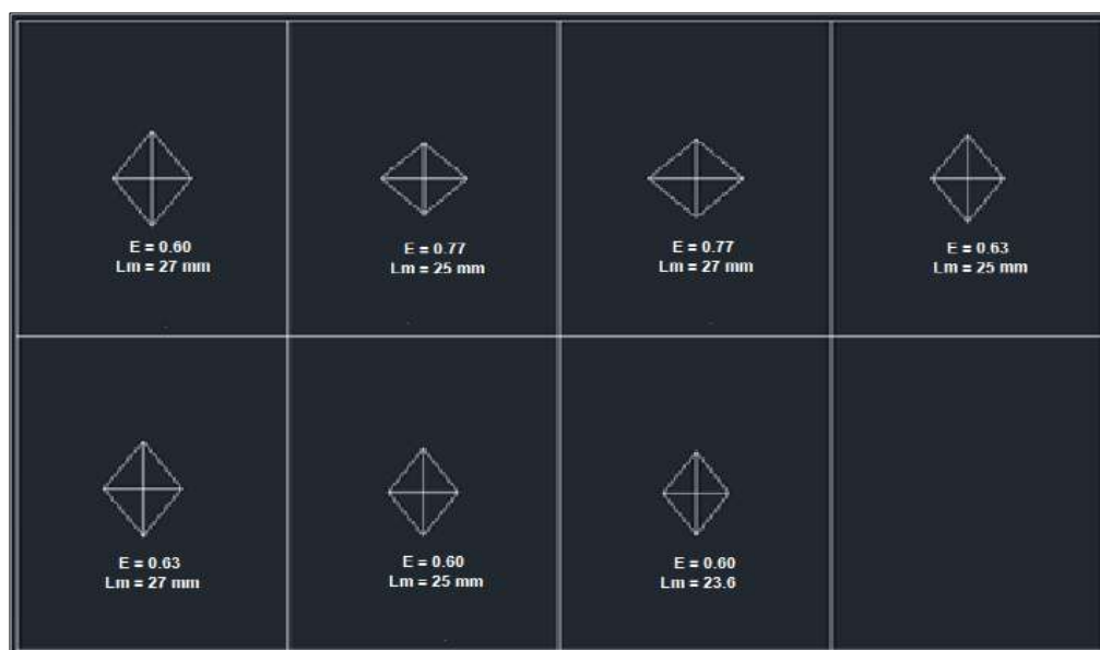
Figura 27. Diseño de las mallas diamantes del acrílico de selectividad en AutoCAD para los ensayos en laboratorio.
