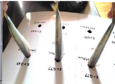
Imagen 4: Ensayos de pejerrey en las mallas diamante
