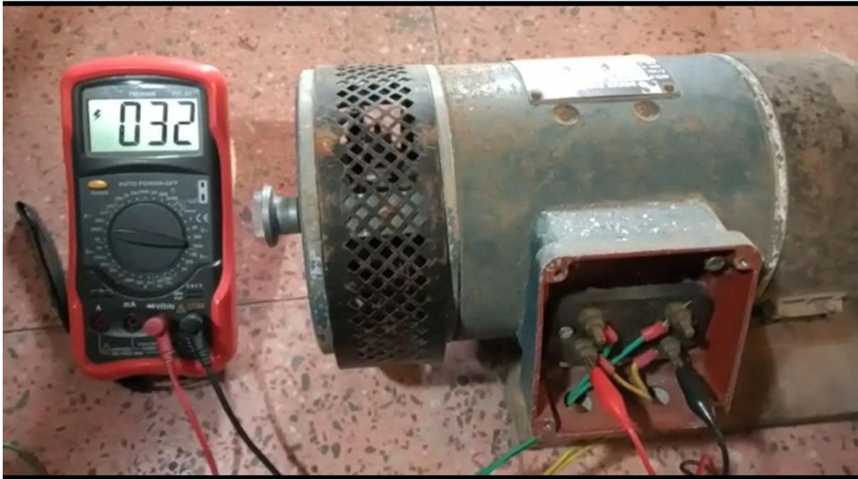
FIGURA 30. Prueba de voltaje en laboratorio con motor de 1HP, 17%. (Elaboración propia)
