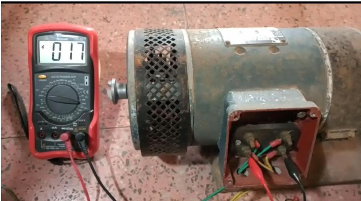
FIGURA 29. Prueba de voltaje en laboratorio con motor de 1HP, 8%. (Elaboración propia)
