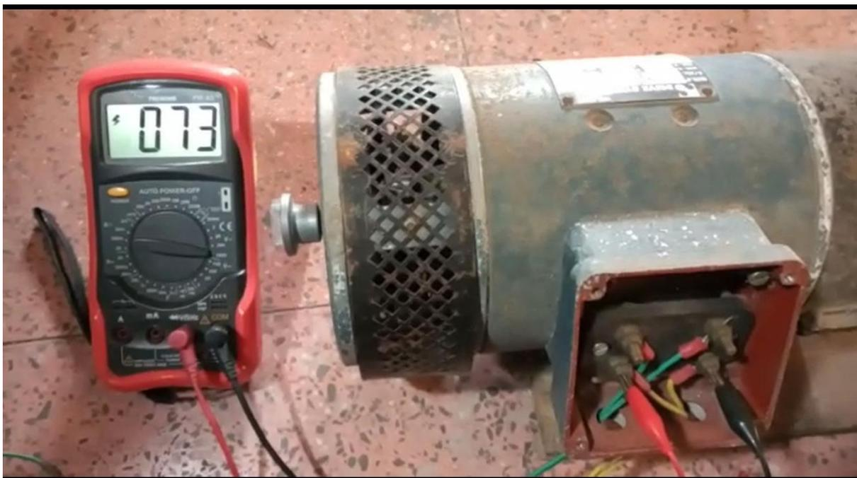
FIGURA 31. Prueba de voltaje en laboratorio con motor de 1HP, 39%. (Elaboración propia)
