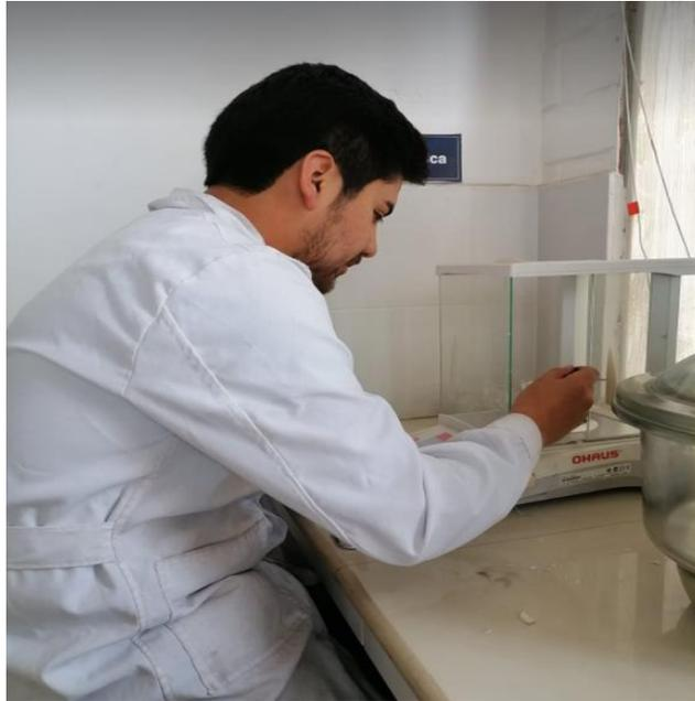
**Figura 6-2:** Pesado de muestras para determinar MO.
