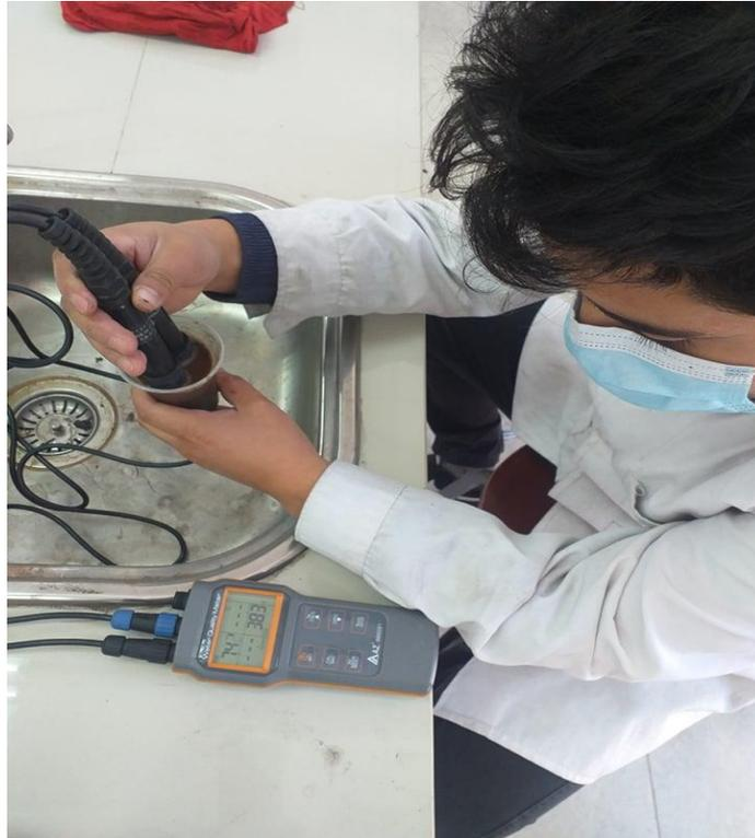
**Figura 5-2:** Determinación de la conductividad eléctrica.
