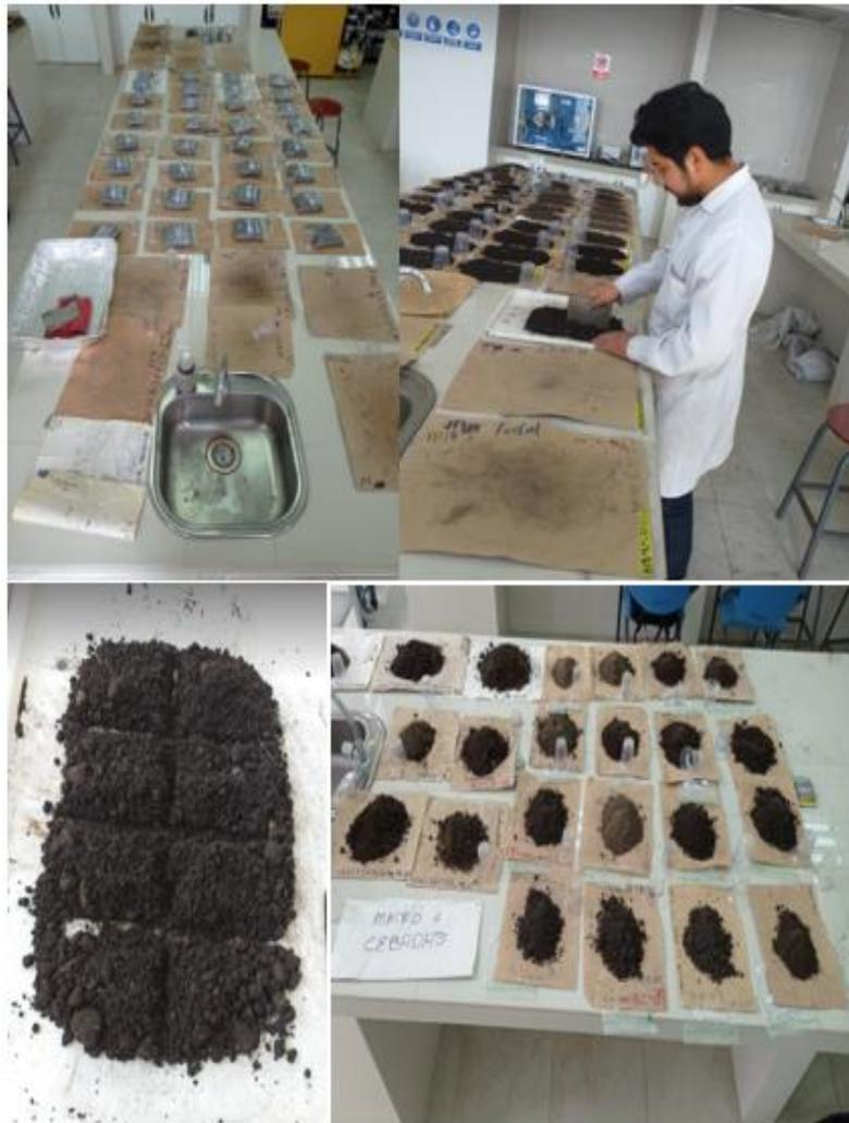
**Figura 3-2:** Elaboración de las submuestras compuestas
