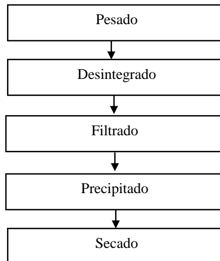
Gráfico 1-1. Diagrama de flujo del proceso de extracción del almidón
