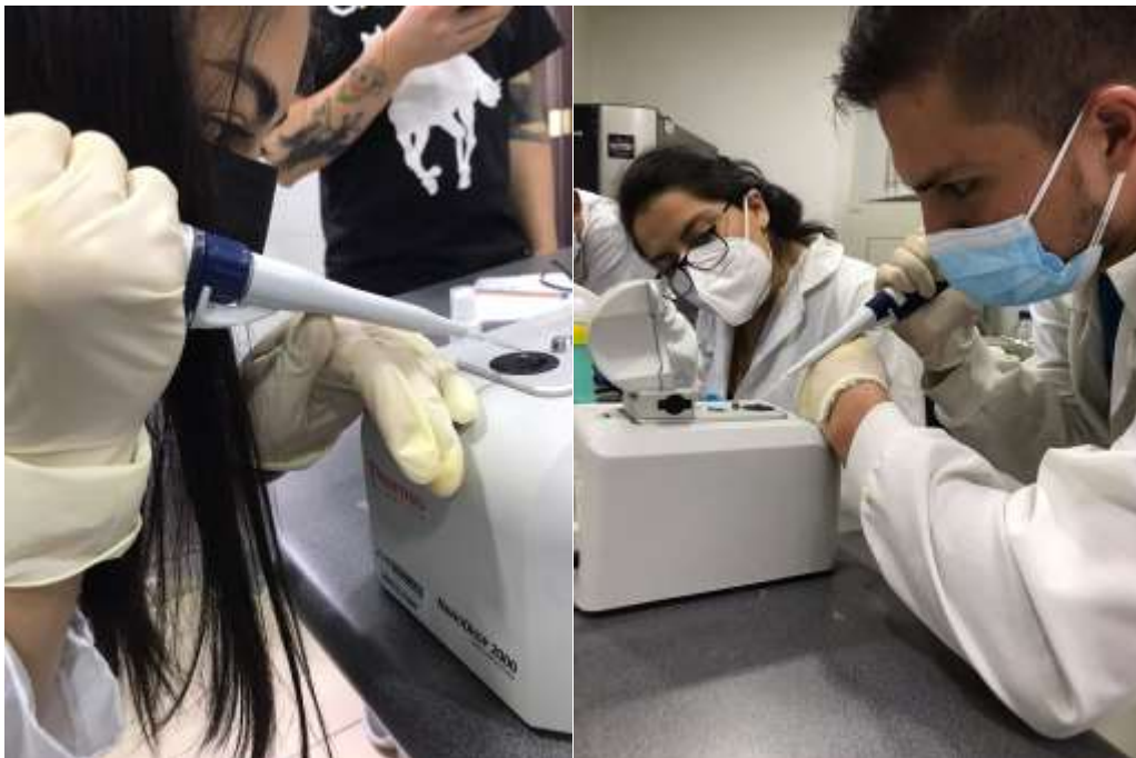
Figura 6-3: Medición de calidad de muestra de ADN mediante Nanodrop 2000
