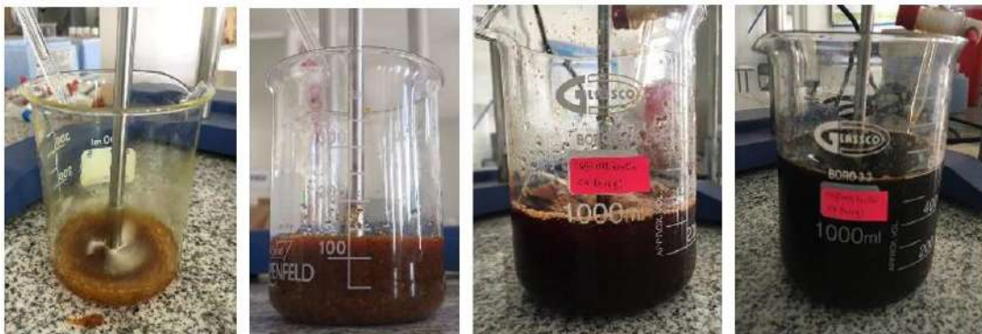
Figura 3-3. Cambio de coloración durante el proceso de coprecipitación de nanopartículas
