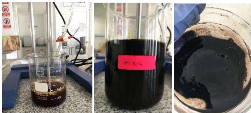
Figura 3-2. Síntesis de NPs de magnetita por el método de coprecipitación
