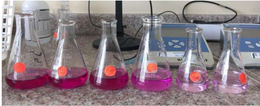
Figura 7-2. Estándares a partir de los cuales se realizó la curva de calibración de Cr (VI)
