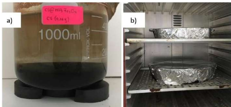
Figura 5-2. a) separación de las Nps mediante decantación magnética y b) secado de las CS/NPsFe 3 O 4 en una estufa a 70 °C
