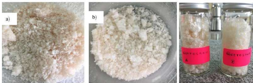
Figura 1-3. a) quitina y b) quitosano obtenido a partir del exoesqueleto del camarón
