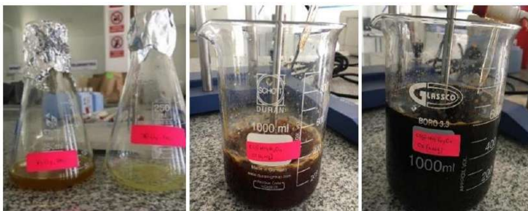
Figura 4-2. Síntesis de CS/NPs \text{Fe}_3\text{O}_4 de manera in situ y por coprecipitación.
