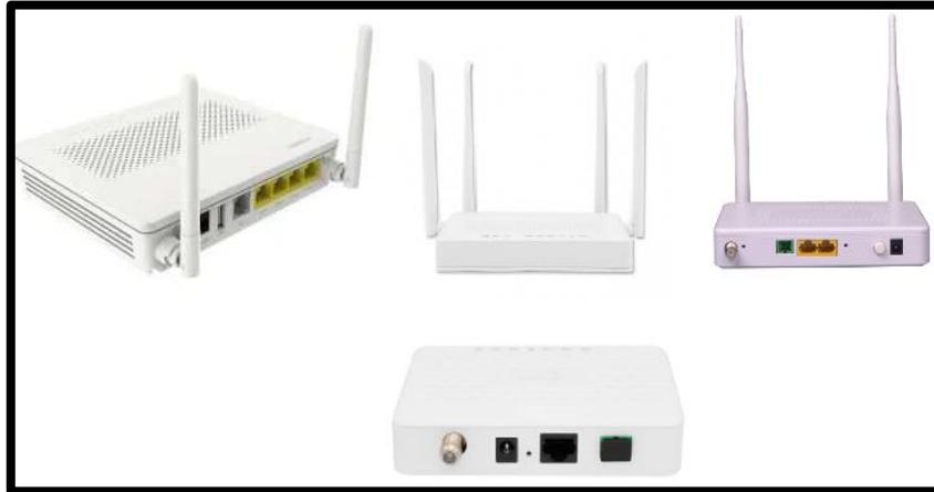
**Figura 12-2.** Diferentes modelos vigentes de ONTs, ONUs o equipo terminal usuario
