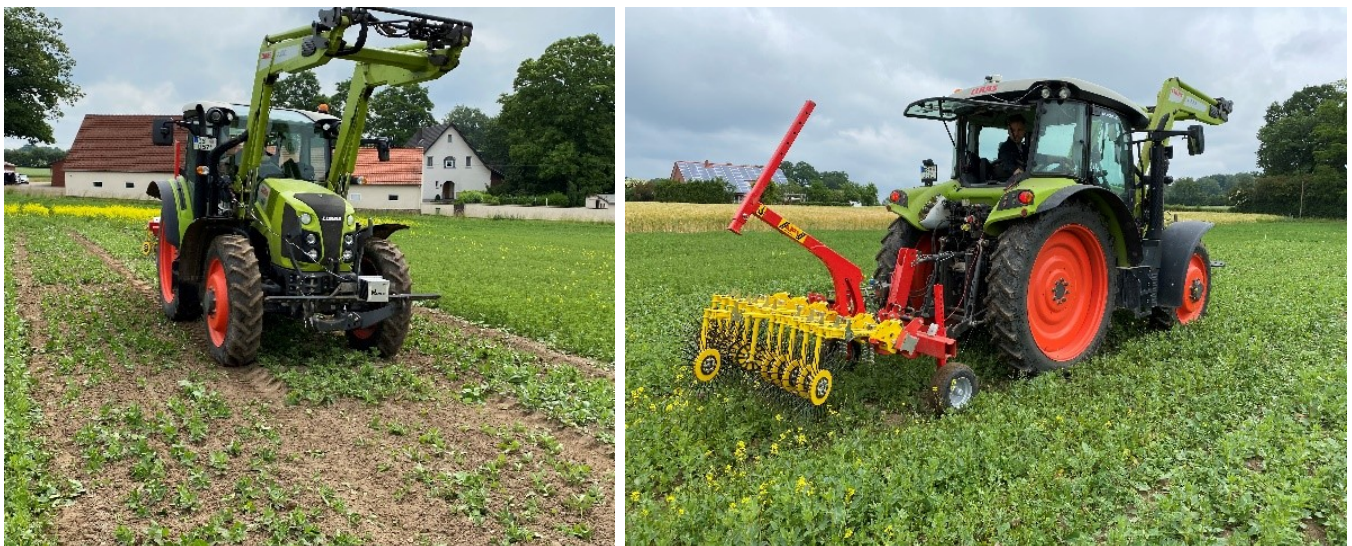
Abbildung 51: Messung mit H-Sensor in der Fronthydraulik des Schleppers (l.), Rollstriegelsegment mit automatischem, hydraulischem Aushub (r.)
