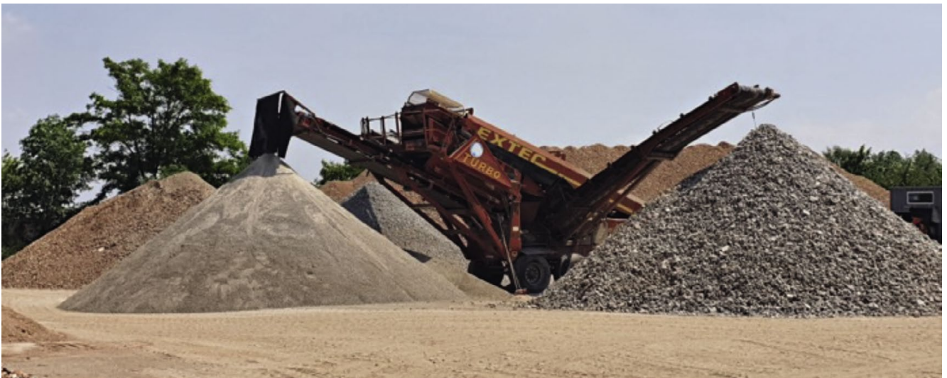
Abbildung 3: Herstellung von rezyklierten Gesteinskörnungen.
