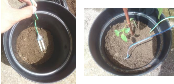
Gambar 3. (a) Pemasangan sensor kelembaban tanah YL-69 di bagian bawah, (b) di bagian atas pada pot
