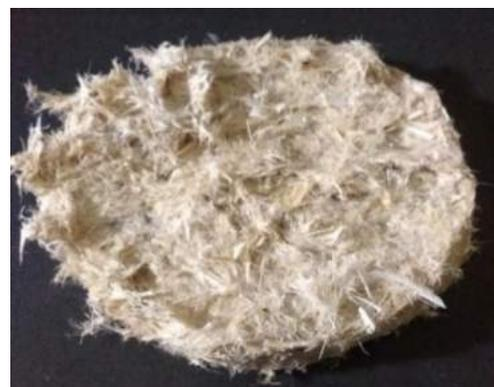
Gambar 8. Panel dibentuk dengan cetakan tipis
