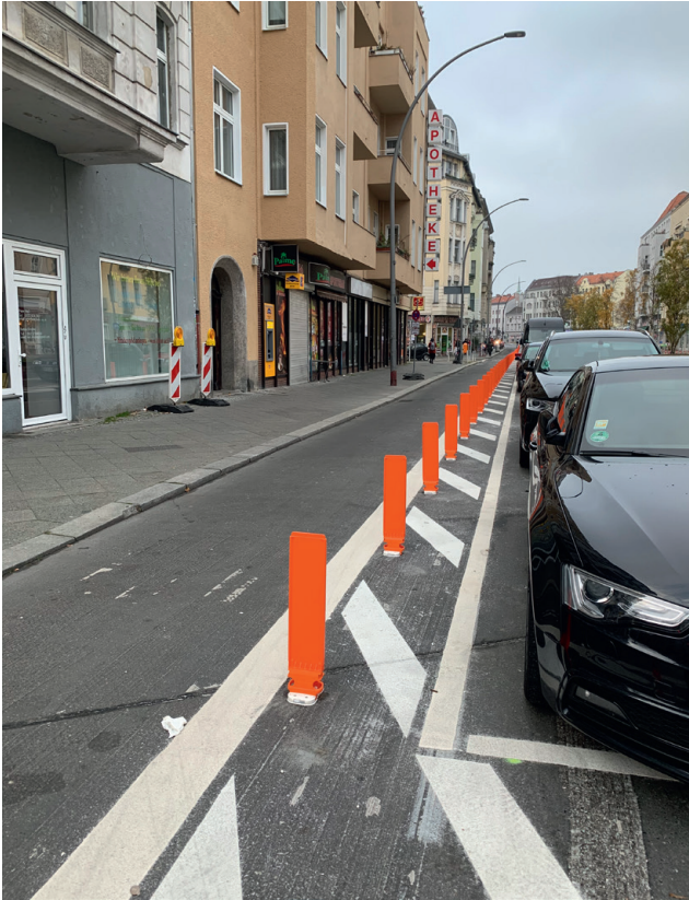
Abbildung 5. Berlin Dudenstrasse, umstrukturierter Seitenstreifen mit Sicherheitszone zum Schutz vor Dooring-Unfällen – hier musste eine Fahrbahn weichen (Quelle: eigene Aufnahme).
