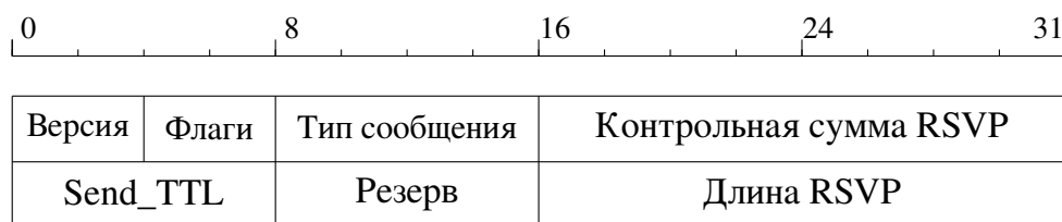
Рис. 8.9. Формат общего заголовка сообщений RSVP
