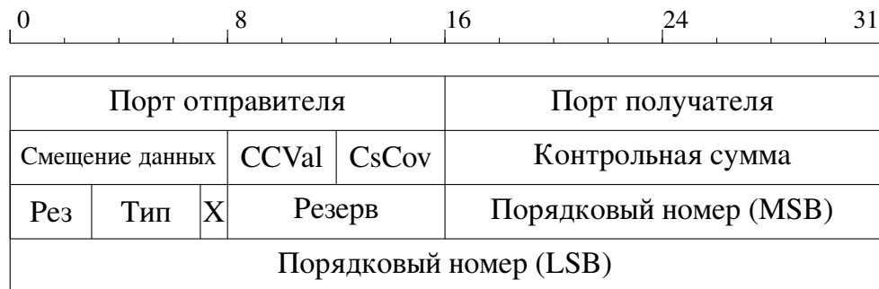
Рис. 6.13. Формат базового заголовка DCCP
