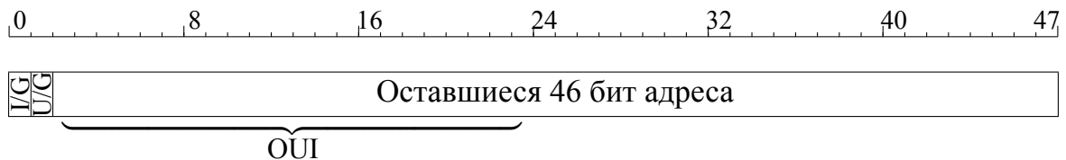
Рис. 4.2. Структура MAC-адреса IEEE. I/G: = 0 — индивидуальный адрес, = 1 — групповой адрес; U/G: = 0 — глобально администрируемый адрес, = 1 — локально администрируемый адрес
