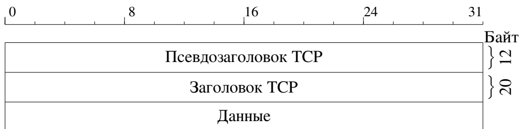
Рис. 6.6. Структура пакета TCP при вычислении контрольной суммы
