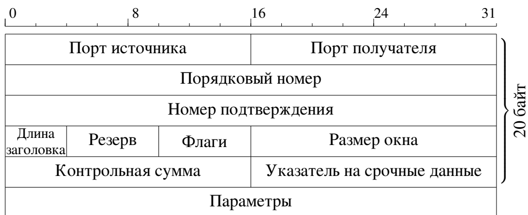
Рис. 6.4. Формат заголовка пакета TCP
