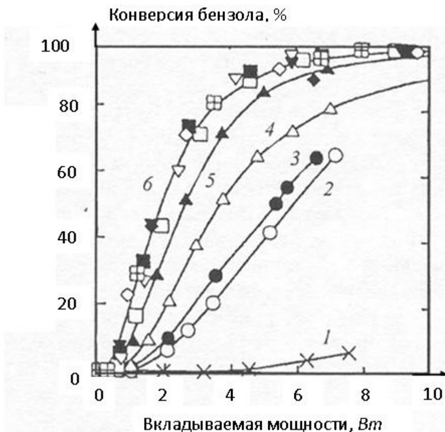
Рис. 4.14. Зависимость степени удаления бензола в сухом воздухе от мощности, вкладываемой барьерным разрядом между диэлектрическими шариками с \epsilon : (1) – 20, (2) – 100, (3) – 200, (4) – 330, (5) – 870, (6) – (1100 – 15000)
