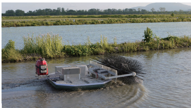
図1 秋田式ロボット除草機の走行テストの様子
