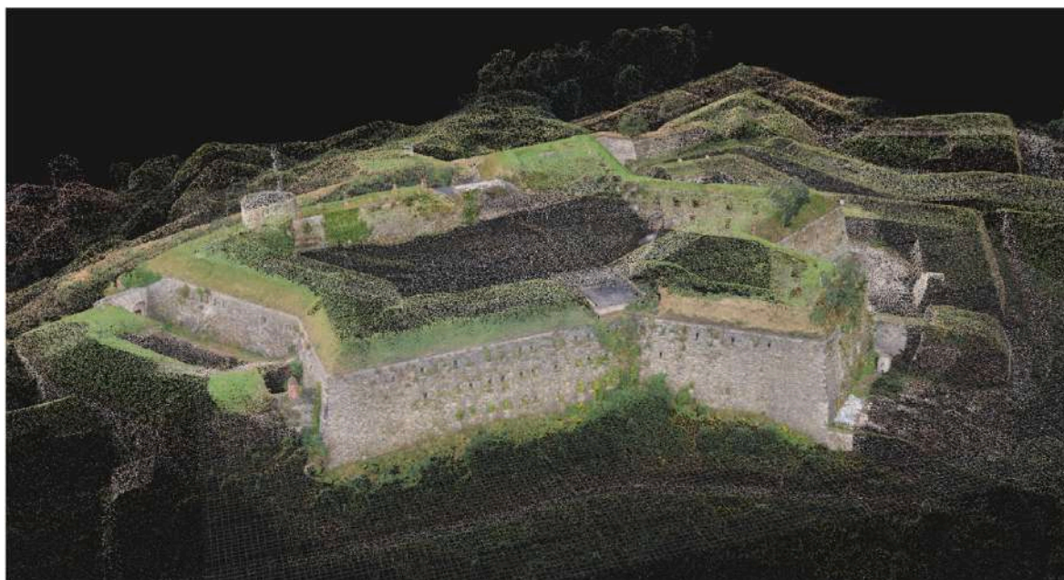
Fig. 12. Photogrammetry 3D model of "Donjon" in Klodzko Fortress based on photos - study by Michał Wac "Cyfryzacja Budownictwa".
