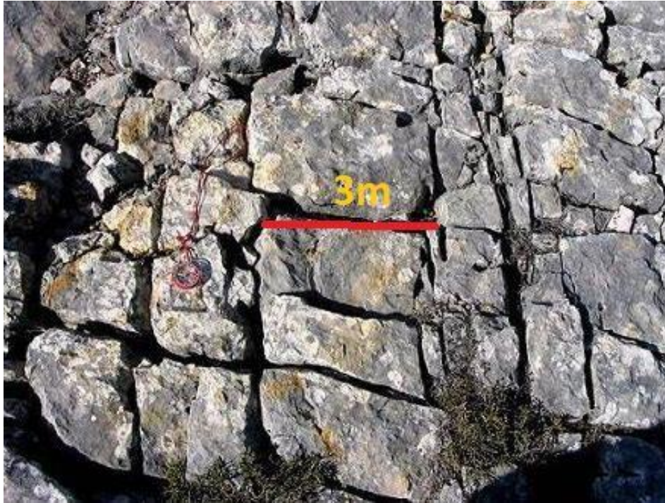
Figura 7. Representación de una diaclasa con separación de 3 metros Tomado de Salcedo SGC ,2019
