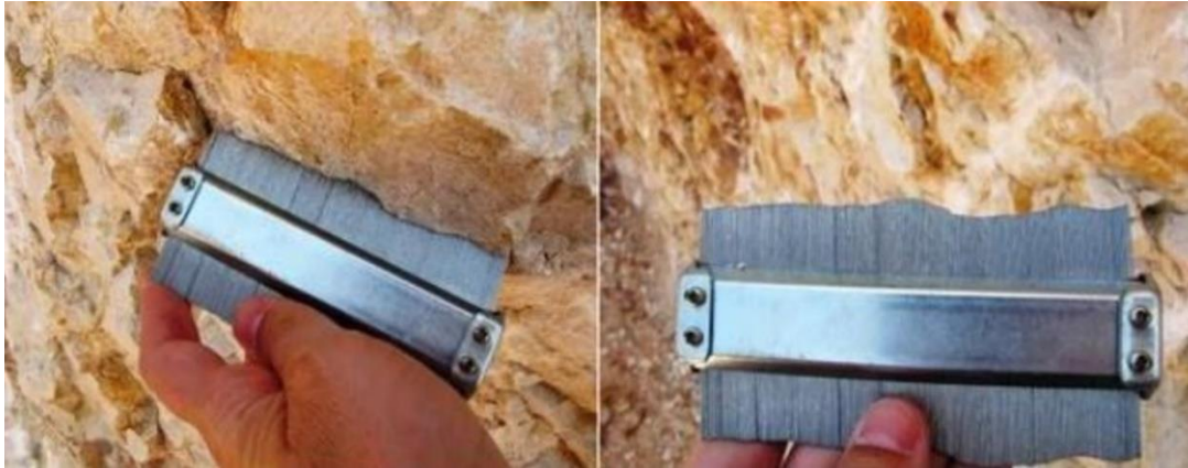
Figura 11. Clasificaciones de la rugosidad de la pared del plano de discontinuidad mediante filometro Tomado de Gonzales de Vallejo, 2002
