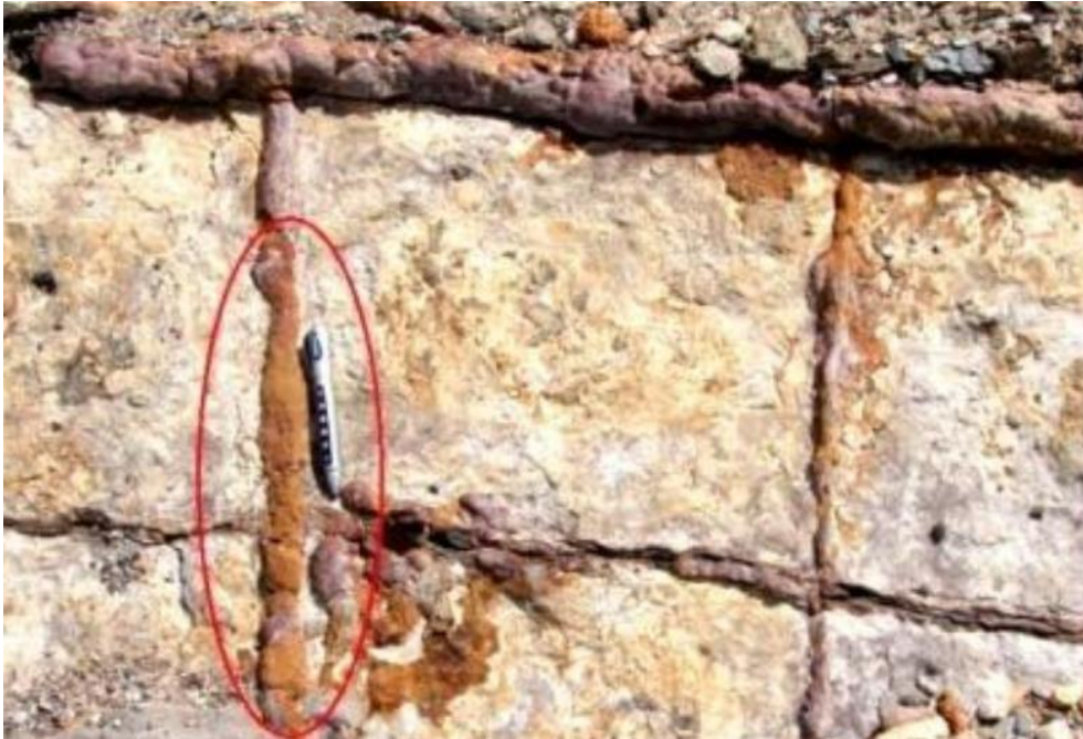
Figura 13. Discontinuidades con material de relleno de óxido de hierro Tomado de Gonzales de Vallejo, 2002
