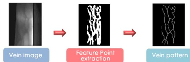
Figura 27: Exemplo de um padrão de veias do dedo extraídos da imagem capturada no leitor
