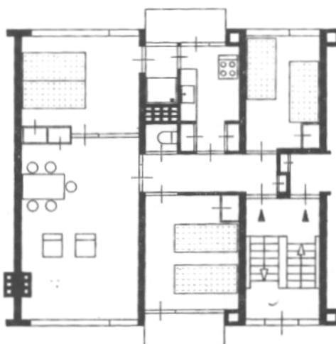
Figura 6.10 – Habitação holandesa do período de reconstrução após a segunda grande guerra. Os elementos estruturais (definidos a escuro) condicionam a adaptabilidade das habitações. [Fonte: Leupen (2006)]
