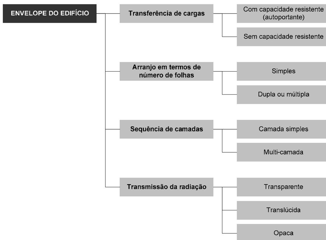
**Figura 3.9 – Classificação do envelope em termos de critérios construtivos**
