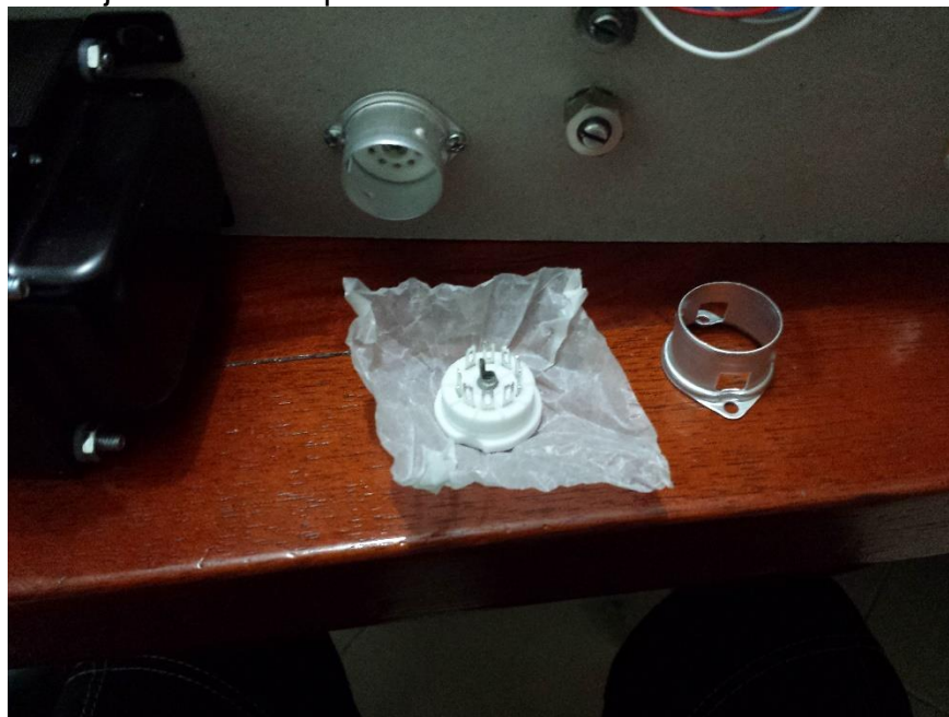
Figura 54. Montaje de Sockets para válvulas
