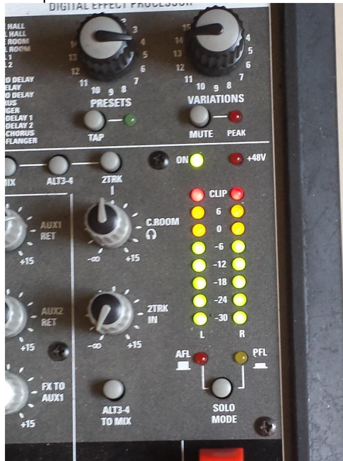
Figura 101. -9dBFS equivalen a +11dBu en la consola utilizada.
