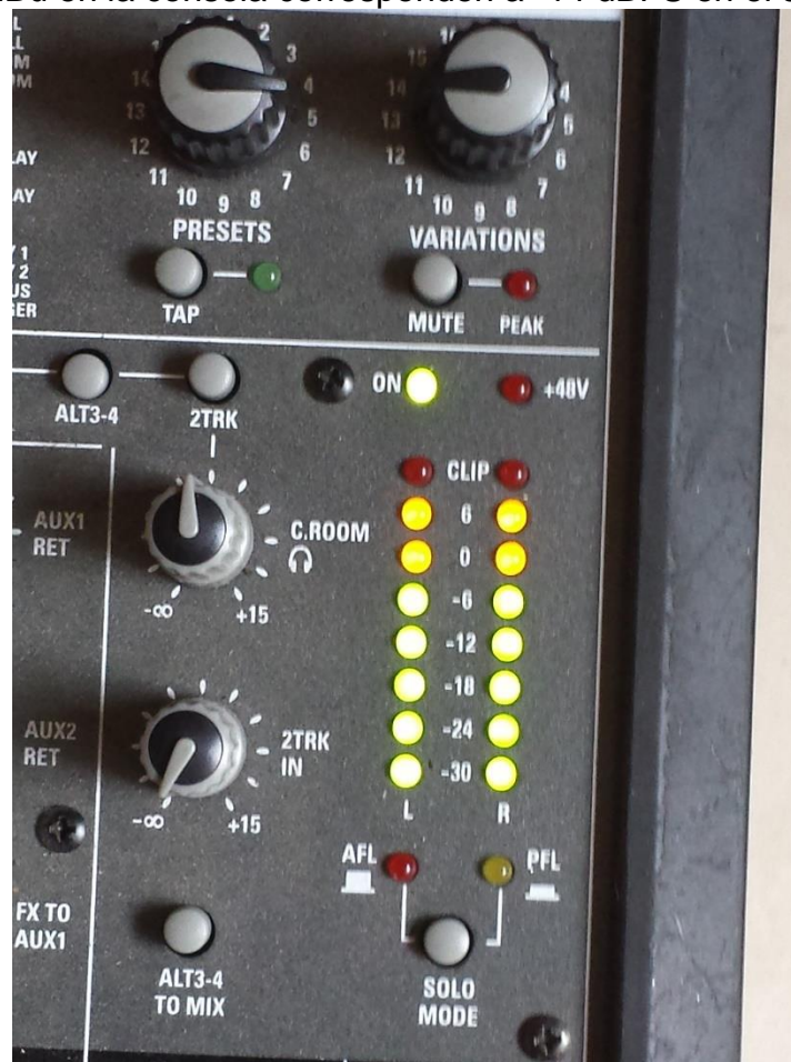
Figura 100. +6dBu en la consola corresponden a -14 dBFS en el sistema.
