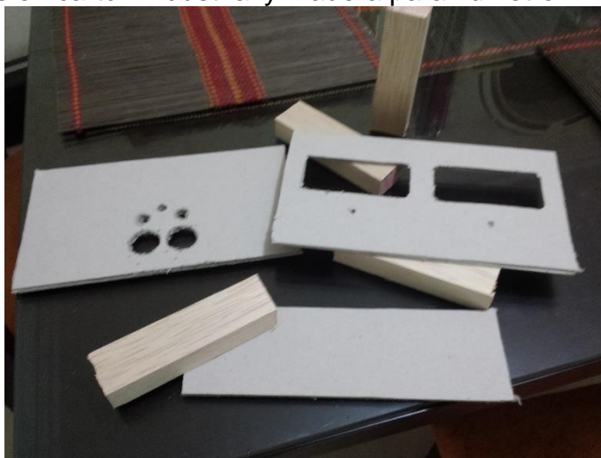
Figura 65. Chasis en cartón industrial y madera para vúmetro.
