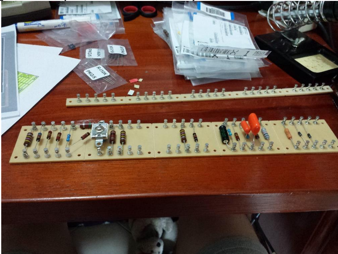
Figura 45. Montaje de condensadores, diodos y resistencias en Turret Board
