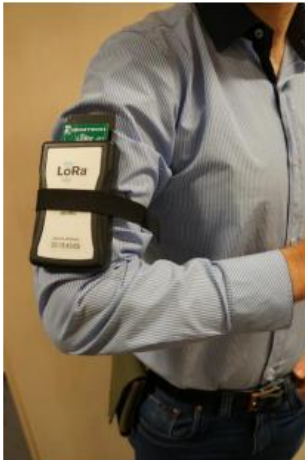
Figura 26 Nodo LoRaWAN para conectar sensores médicos a una estación base [17]
