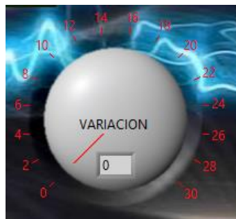
Figura 13. control de la variación de frecuencias entre el lado izquierdo y derecho en Labview
