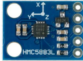
Figura 4. Brújula digital HMC5883L [9]
