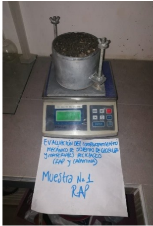
Fotografía No. 7: Molde para ensayo de Próctor modificado y CBR de laboratorio
