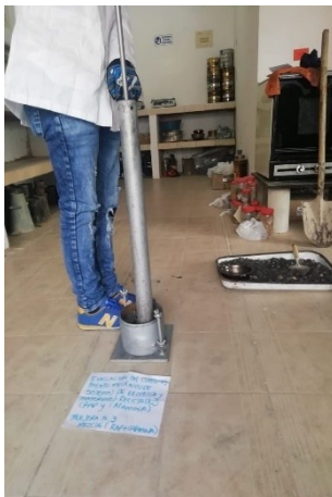
Fotografía No. 15: Ensayo de Próctor modificado
