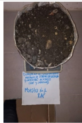
Fotografía No. 4: Muestra para ensayo de granulometría
