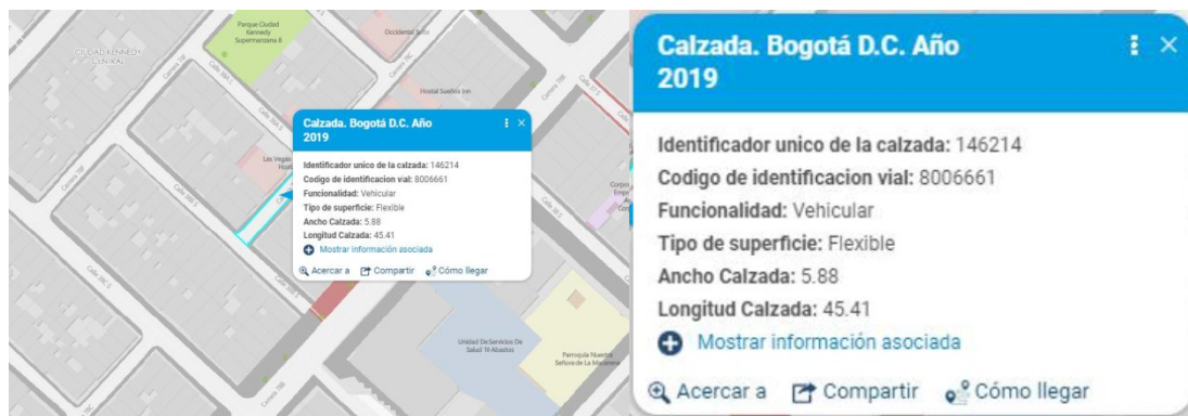
Figura 36. Características geométricas del segmento a modelar.
