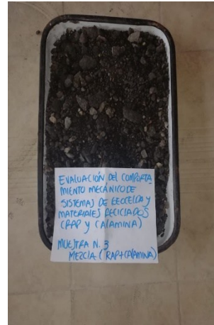
Fotografía No. 14: Muestra fórmula de trabajo: RAP y Calamina
