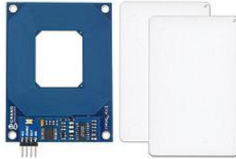
Figura 6. Módulo de lectura RFID EM4100 y tarjeta. [9]
