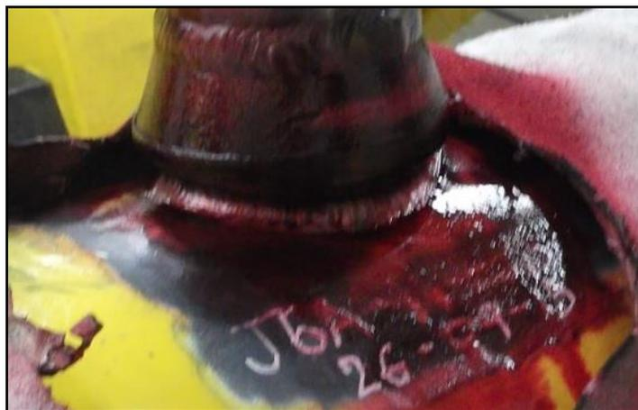
3. **Aplicación Revelador:** Una vez pasa el tiempo de penetración se realiza una segunda limpieza exhaustiva para retirar todos los excesos de penetrante y poder garantizar que las indicaciones arrojadas por el ensayo son reales. Pasados unos minutos de la limpieza se procede a aplicar el revelador el cual por efecto de capilaridad mostrara las indicaciones con un tono rojizo. (Ver ilustración 44).
