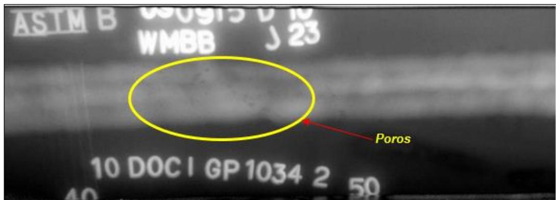
Una vez se determina que hay que realizar la reparación se genera un CALCO este calco es una copia calcada directamente de la placa a mano alzada, el cual se dispone en la parte del tubo que tiene marcada la misma sección y se ubica el defecto posteriormente se realiza la reparación y una nueva toma de la sección reparada para su aprobación. (Ver ilustración 40 y 41).
