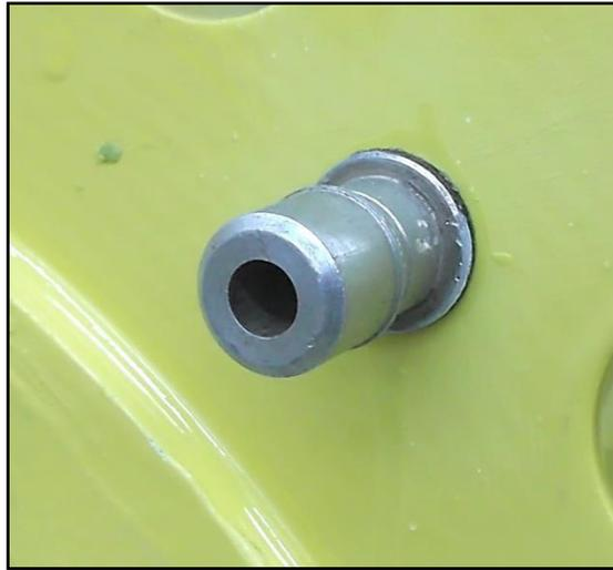
*Ilustración 51. Montaje de Ensayo d Adherencia*
