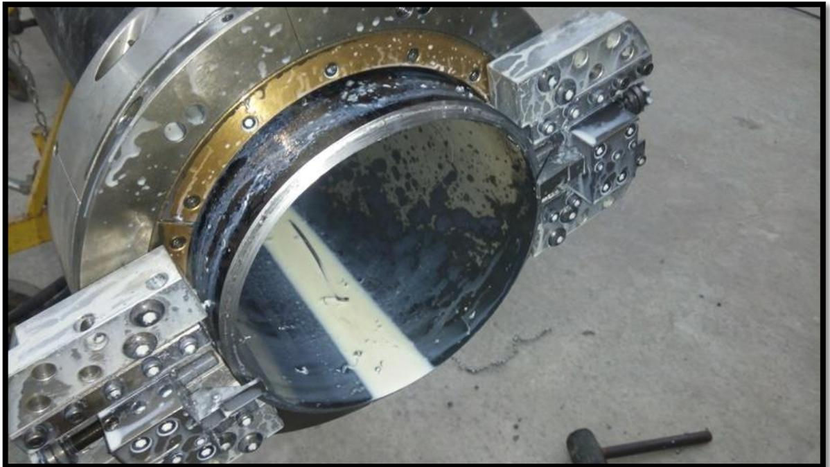
En la ilustración 28 se puede observar la biseladora semiautomática, el proceso de biselado en un tubo de 8”.
