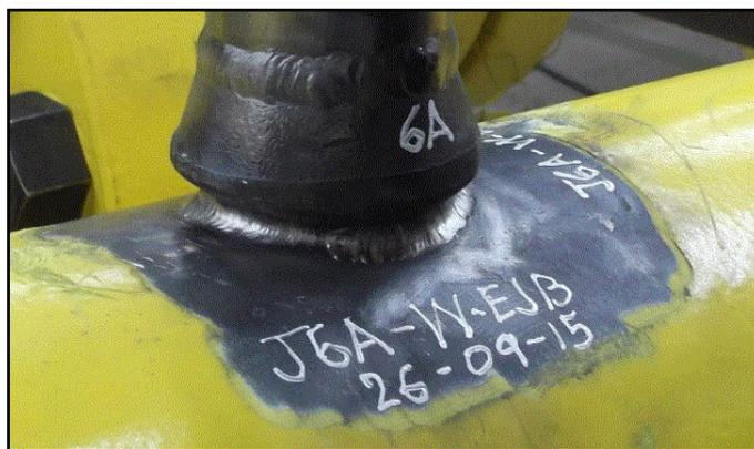
2. **Aplicación Penetrante:** la aplicación del penetrante se realiza a lo largo de la junta a inspeccionar, el líquido penetra en las discontinuidades y se deja en un tiempo estimado dependiendo de las condiciones ambientales entre 1 a 20 min. (Ver ilustración 43).
