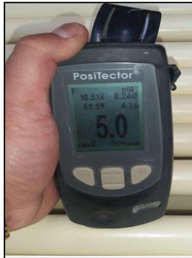
Una vez aplicada la última capa del acabado (acrolon) se realiza la medición cuando la pintura ya está seca, los espesores del acabado deben tener un rango de (3-4) es decir cuando se realiza la medición final el rango del espesor de todo el esquema de pintura debe encontrarse entre (7-10mils). (Ver ilustración 49).
