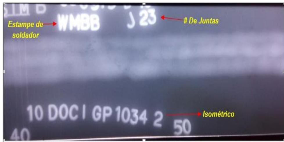
*Ilustración 37. Marcación Placa Radiográfica.*
