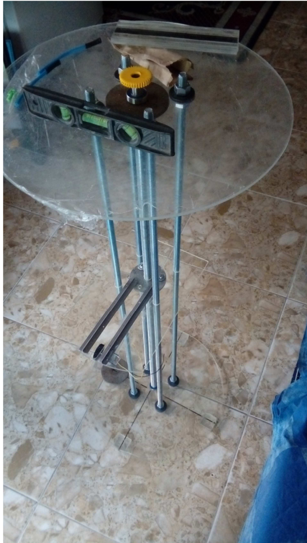
Figura 11. Estructura con las circunferencias y tornillos de soporte. Autoría propia
