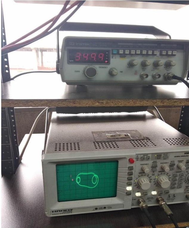
Figura 52: Diagrama de fase a 350Hz Osciloscopio
