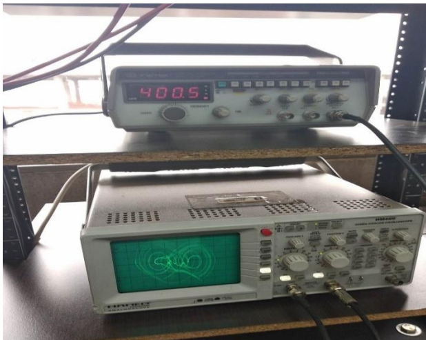
Figura 54: Diagrama de fase a 400Hz Osciloscopio.
