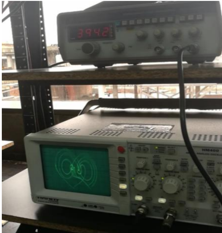
Figura 43: Diagrama de fase circuito elaborado. Osciloscopio Diotronic HM400. Fuente: Elaboración propia
