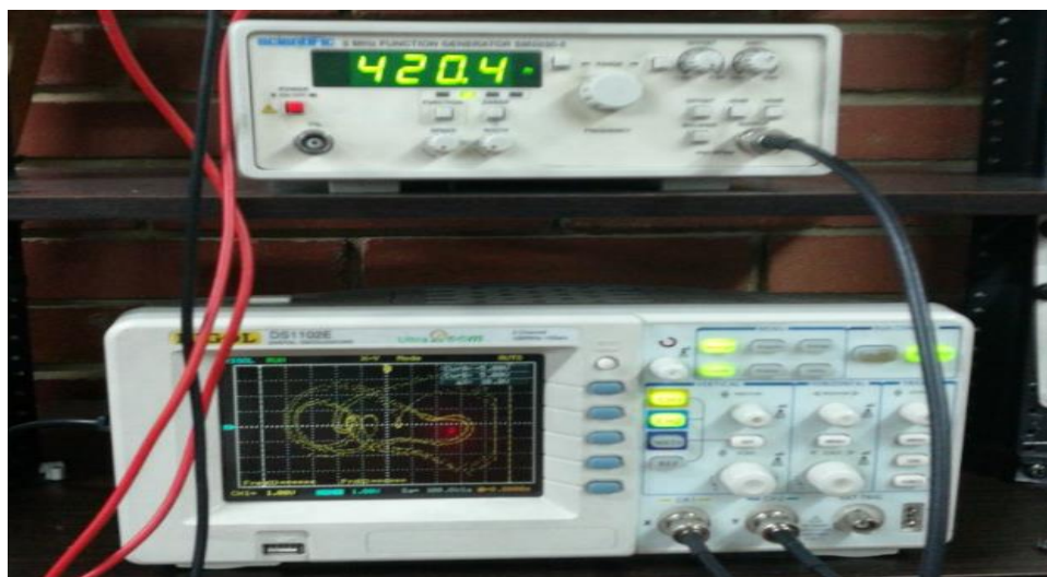
Figura 42: Diagrama de fase circuito elaborado. Osciloscopio Rigol DS1000E. Fuente: Elaboración propia
