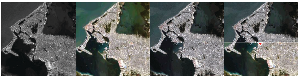
Figura 4 – Imagen pancromática (Izquierda), multiespectral (centro) y fusionada de Landsat 8 OLI TIRS – Sentinel 2 (derecha) por la transformada Wavelet Coiflet 2, nivel de descomposición 4.
