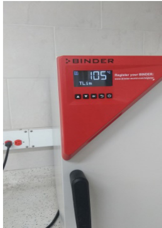
Figura 2 – Eliminación de humedad en horno eléctrico
