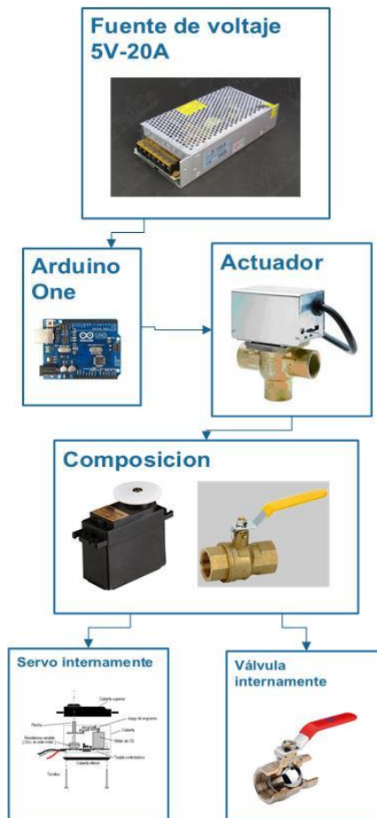
Figura 11. Esquema del actuador [34][50][51]
