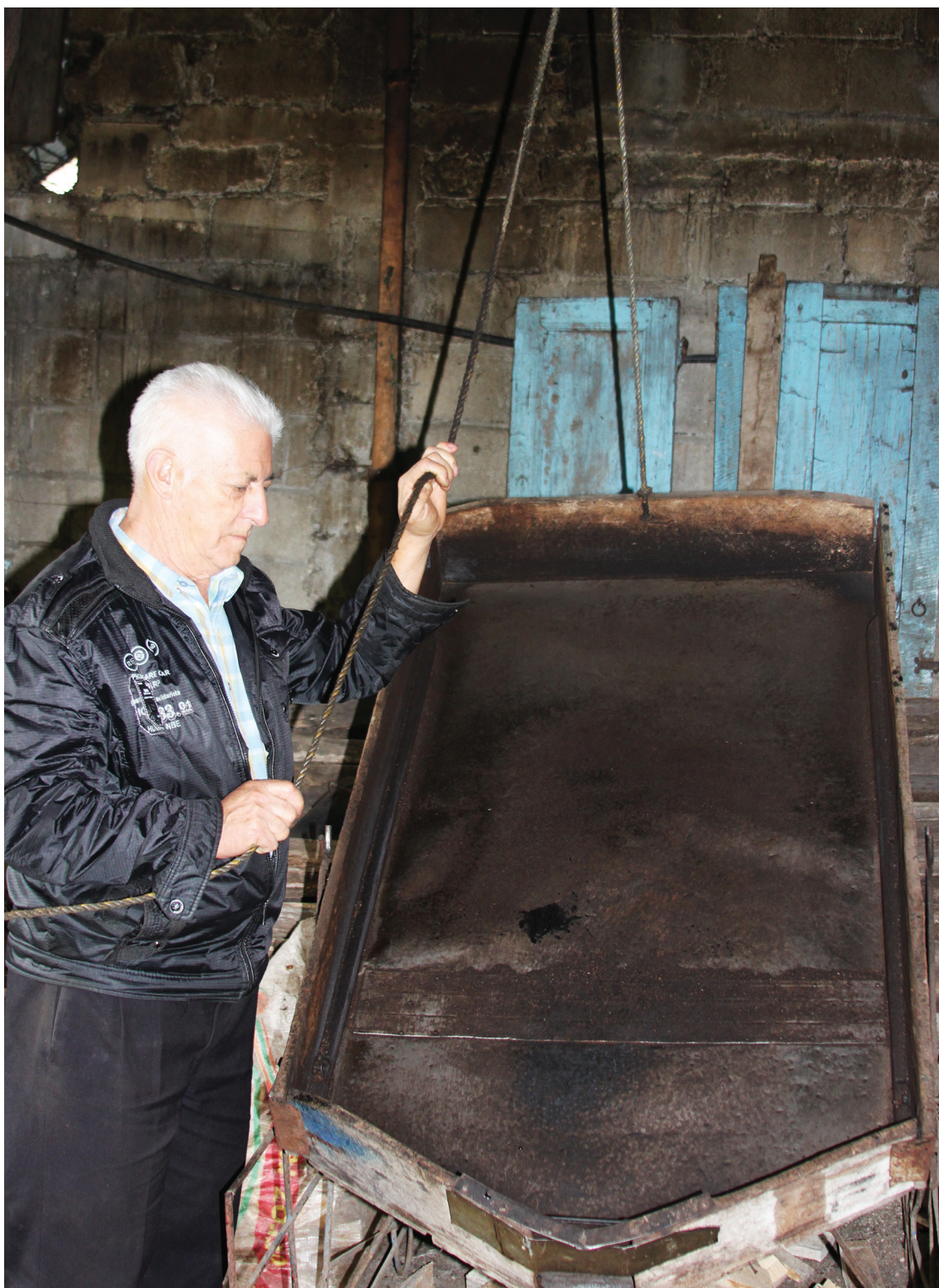
Enfriador de café recién tostado, construido por Fenelón Muñoz Delgado, con el propósito de pasar fácilmente el grano a los sacos. Fotografía: Jesús Holmes Muñoz. 2013.
