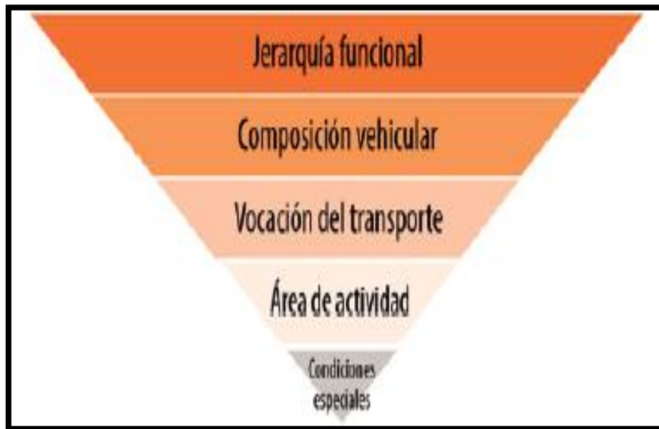
Figura 4 Variables influyentes en la selección del vehículo de diseño. Fuente: Guía de Diseño Urbano de Bogotá.
