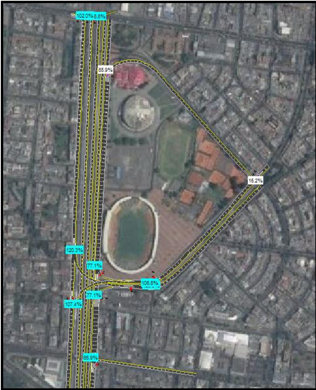
Imagen 32 capacidad de utilización de la intersección (ICU). Fuente. Elaboración propia basada en Google. (s.f.). [Mapa de Bogotá, Colombia en Google maps] recuperado el 15 enero de 2016, de https://www.google.com.co/maps/@4.6446676,-74.0788402,17z
