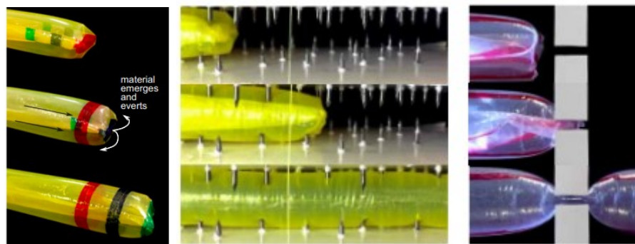
Figura 12. Funcionamiento del robot blando extensible (izq.), pruebas de desempeño (cen. y der.). Fuente: [47]
