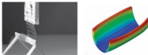
Figura 5. Lámina de elastómero dieléctrico usada como actuador para tomar un objeto. Fuente: Modificado de [31]
