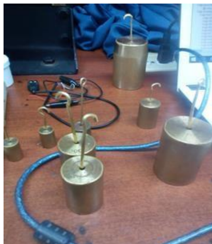
Figura 12. Proceso de calibración para la celda de carga
