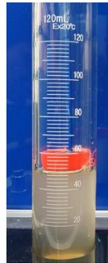
**Figura 21: cantidad de líquido depositada por un inyector con exceso de consumo
