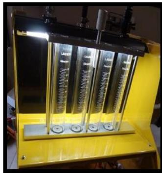
**Figura 3: probador de inyectores de gasolina activado y controlado vía Wi-Fi.
