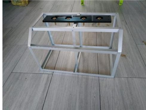
**Figura 6: esqueleto en ángulos de aluminio. Fuente: Propia.**
