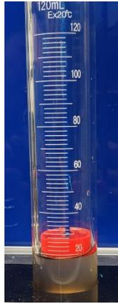
**Figura 22: cantidad de líquido depositado por un inyector en buen estado. Fuente: Propia.**
