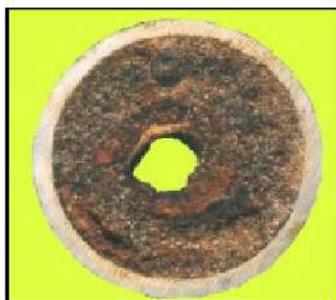
Figura 2.1: Entupimento de Tubulação Causado por Deposição de Orgânicos Pesados
