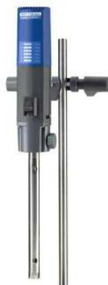
Figura 26 – Dispersor utilizado nos experimentos.
