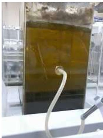
Figura V.2: Lixiviado após o tratamento por coagulação/floculação/sedimentação.
