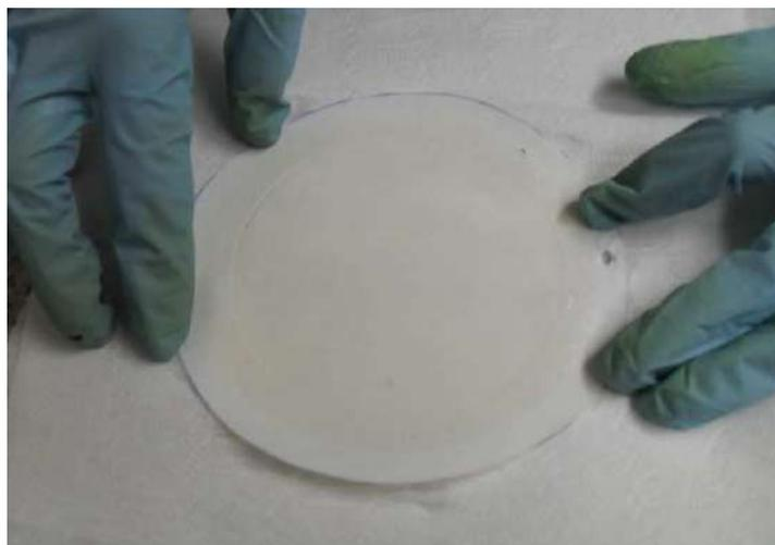
Figura V.15: Adsorção de solutos na membrana NP010 após filtração
