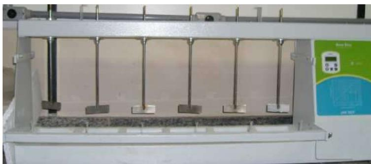
Figura IV.1: Aparelho de *Jar-Test* utilizado para realizar a coagulação/floculação/sedimentação
