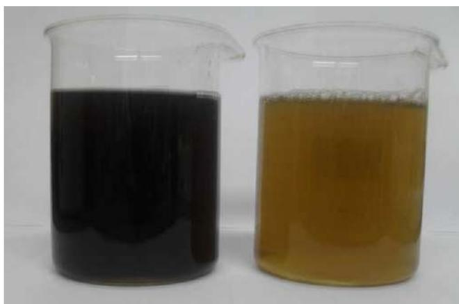
Figura V.3: Remoção de cor no lixiviado tratado por coagulação/floculação/sedimentação em relação ao lixiviado bruto
