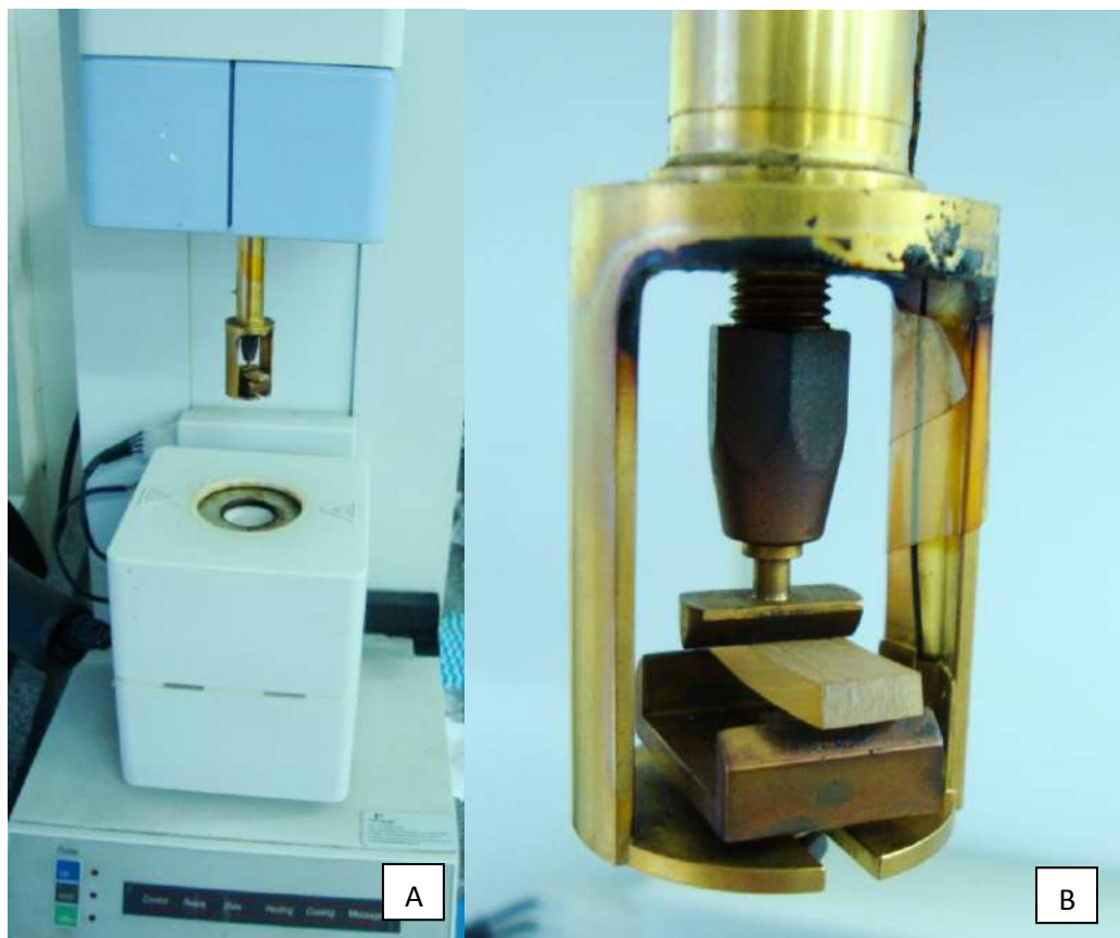
Figura 3.3. A) DMA modelo 7e da Perkin Elmer; B) Detalhe da flexão de três pontos.
