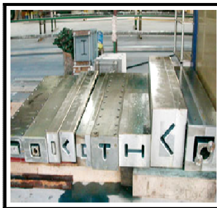
Figura 2.6. Moldes de pultrusão com cavidades de diferentes geometrias.
