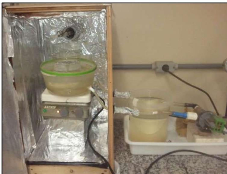
Figura 10. Reator de UV utilizado nas reações de degradação.
