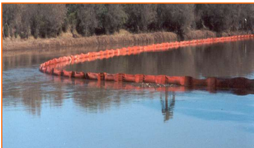
Figura 4.1 - Exemplo de Barreira de Contenção. Fonte: REDUC (2005)
