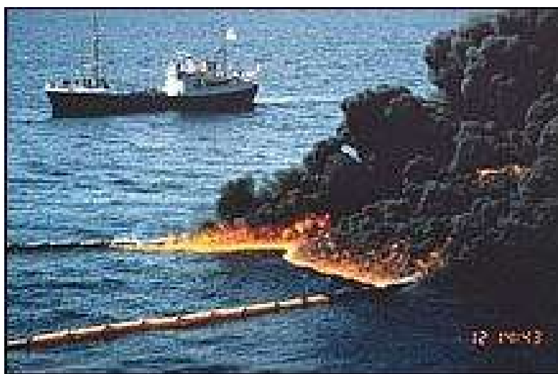
Figura 4.9 - Exemplo da utilização do “ Fire Boom ”.
