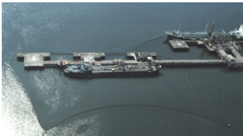
Figura 4.3 - Exemplos de barreiras de contenção permanentes.
