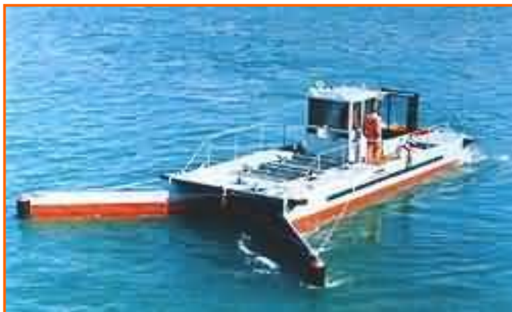
Figura 4.7 - Exemplo de Embarcação / Skimmer.
