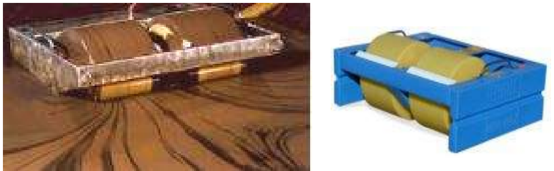
Figura 4.6 - Tipos de skimmers para retirada de óleo.
