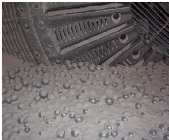
Figura II.3 – Interior de um moinho de bolas da indústria cimenteira (Silva, 2007)
