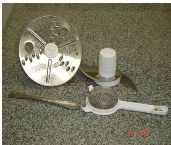
Figura 5.7: Laminas utilizadas para o despeculiamento e redução do tamanho das sementes
