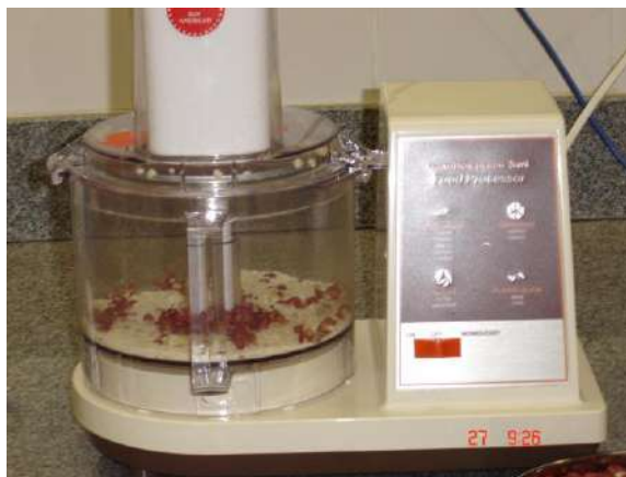
Figura 5.6: Processador utilizado para o despeliamento e redução do tamanho das sementes
