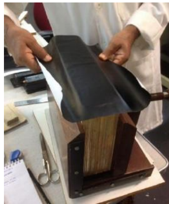
FIGURA 41- Adesão do reforço (vulcapel) à falsa lombada. Fonte: fotografia da autora, 2017.
