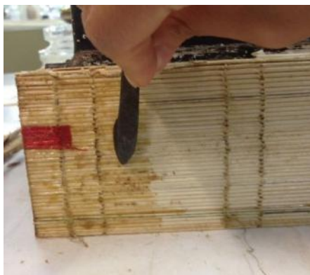
FIGURA 9- Limpeza do excesso de adesivo do lombo. Fonte: fotografia da autora, 2017.
