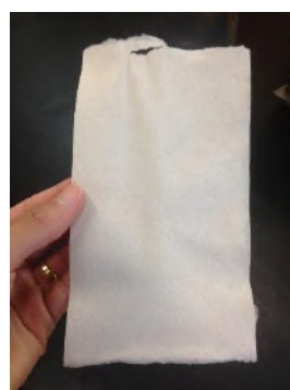
FIGURA 20- Folha da Máquina Obturadora de Papel (MOP) pronta, após duplicação da espessura. Fonte: fotografia da autora, 2017.
