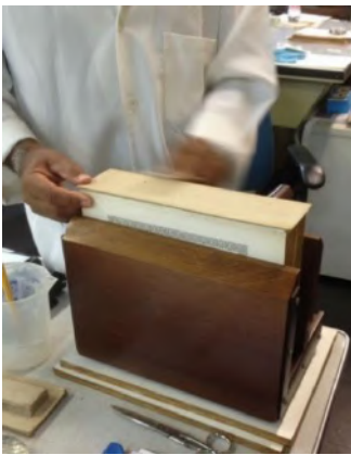
FIGURA 40- Adesão da falsa lombada ao lombo. Fonte: fotografia da autora, 2017.
