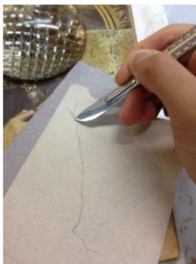
FIGURA 23- Corte do molde com bisturi. Fonte: fotografia da autora, 2017.
