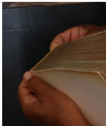
FIGURA 32- Fixação e verificação para o nivelamento do cabeceado na altura certa. Fonte: fotografia da autora, 2017.
