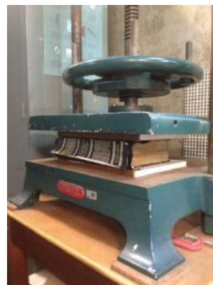
FIGURA 43- Prensagem do livro. Fonte: fotografia da autora, 2017.
