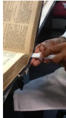
FIGURA 45- Virada do reforço sobre cabeça e pé da lombada, utilizando uma espátula. Fonte: fotografia da autora, 2017.
