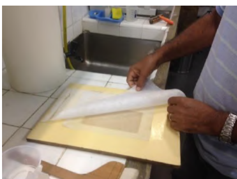
FIGURA 19- Selagem com um pedaço de TNT branco limpo. Fonte: fotografia da autora, 2017.
