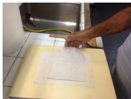
FIGURA 18- Colocação da folha da Máquina Obturadora de Papel (MOP) em superfície plana, para realização da duplicação da espessura. Fonte: fotografia da autora, 2017.
