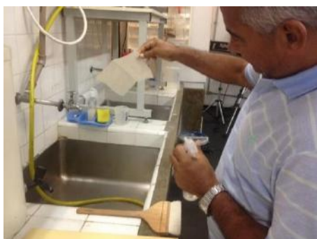
FIGURA 17- Umedecendo folha da Máquina Obturadora de Papel (MOP) com aspersão de água. Fonte: fotografia da autora, 2017.
