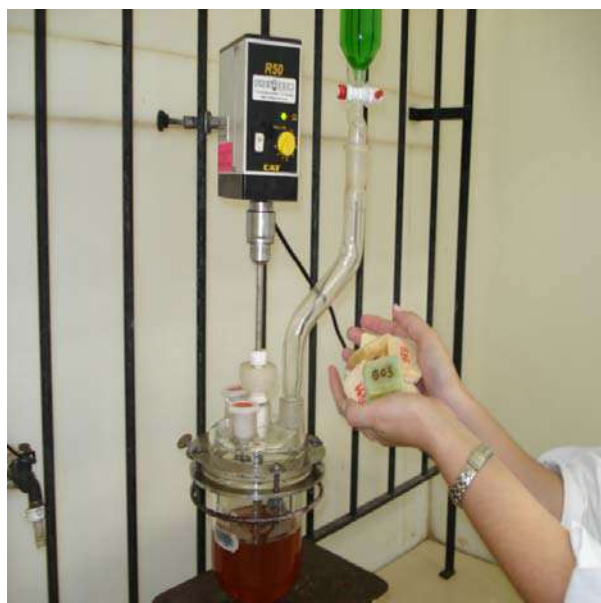
Figura 4.3 - Aparelhagem para produção de sabão a frio
