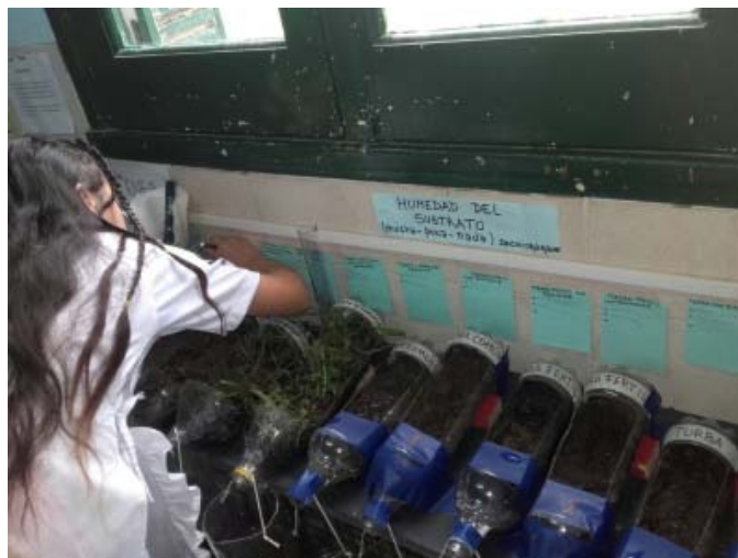
Figura 5. Bandejas utilizadas para observar la erosión del suelo y la escorrentía del agua. Se muestran los diferentes tratamientos comparados por los alumnos: con/sin pendiente distintos tipos de sustrato con/sin cobertura vegetal. Fuente: Todos los autores.
