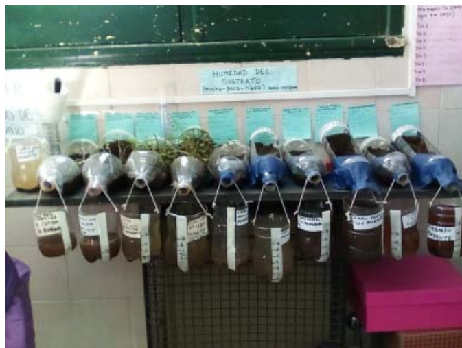
Figura 7. El agua de escorrentía fue recolectada durante una semana en vasos colectores. Fuente: Todos los autores.
