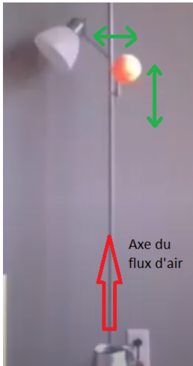
Figure 3.9 – Balle de ping-pong en lévitation sous un souffleur (sèche-cheveux) en position droite. Les flèches vertes montrent l’amplitude des oscillations de la balle et la flèche rouge donne l’axe du flux d’air. La gravité dirigée vers le bas est donnée par l’axe du poteau de la lampe en arrière-plan.
