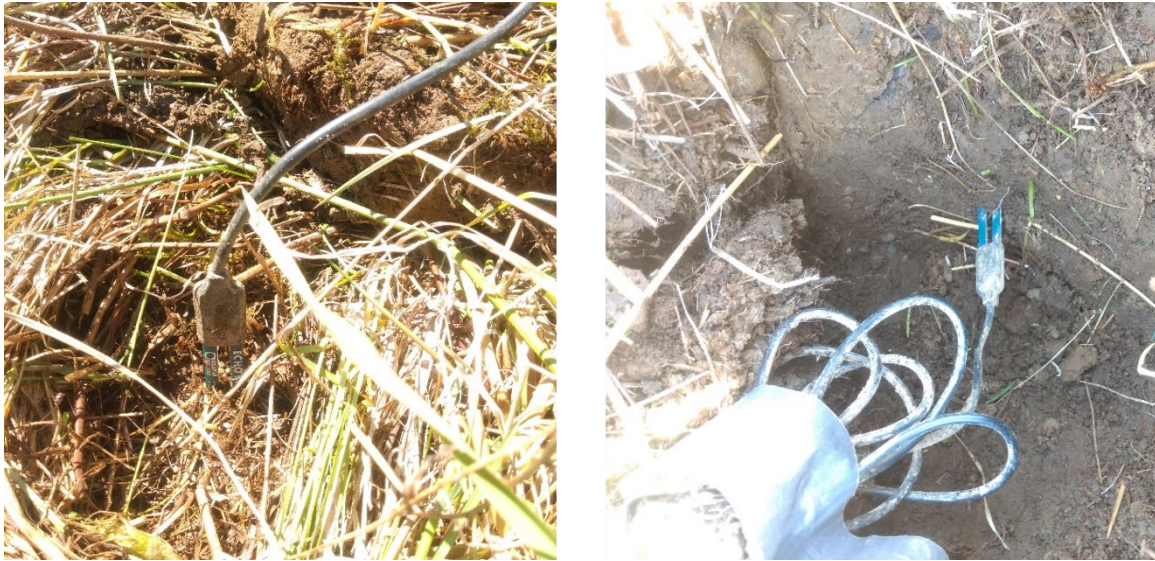
Figure 3.16 - Illustrations d'installation de sondes d'humidité du sol en surface (gauche) et en profondeur (droite)
