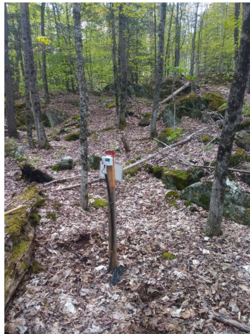
Figure 3.13 - Illustrations d'installation de sondes d'humidité du sol en milieu ouvert (gauche) et en milieu forestier (droite)
